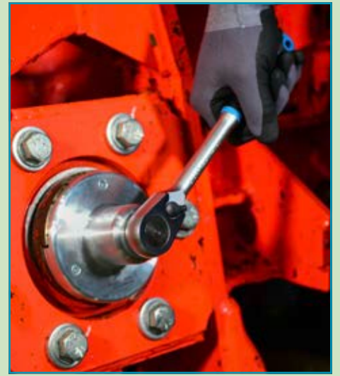
Ovládání pomocí ráčny díky 1/2" (12,5 mm) 4hr. uchycení
